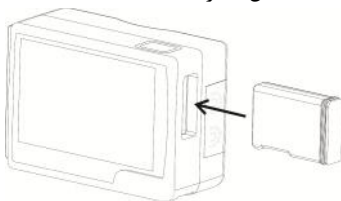
شکل (۶-۱) طرز قرار گرفتن باطری داخل آریا
