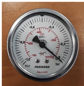
شکل شماره ۳- گيج فشار دستگاه ساکشن
