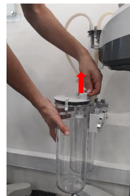
مرحله سوم: خروج مخزن از گیره نگهدارنده با حرکت آن به سمت بالا
