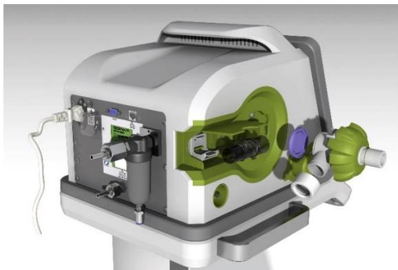
شیر بازدمی، واسط شیر و سنسور فلوی بازدمی و ممبرن آنرا از دستگاه جدا کنید. هنگام بستن شیر بازدمی دقต کنید که ممبرن در جهت درست قرار داده شود. پس از قرار دادن ممبرن، صفحه دایره شکل استیل باید توسط کاربر قابل رویت باشد.
