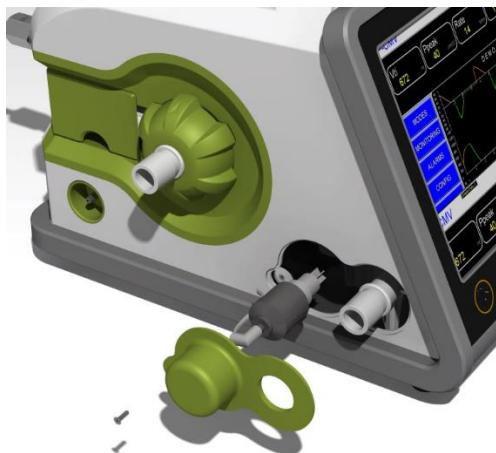
پیچ روی درپوش سنسور اکسیژن را باز کرده و درپوش را بردارید. سنسور اکسیژن را به دقت از جای خود درآورده و آنرا با سنسور سالم تعویض کنید. دقت کنید که کابل ارتباطی مربوط به سنسور اکسیژن را بصورت مناسب وصل کنید.
