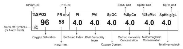
Figure 3-31 Rainbow parameters display
