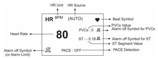
Figure 3-7 ECG parameter area
